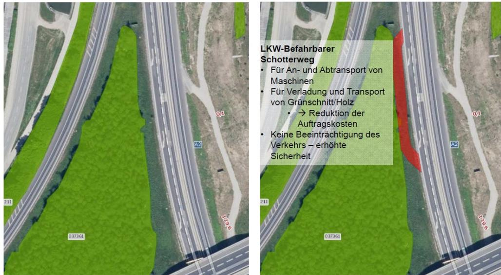
**Abbildung 1: Anlage eines LKW-befahreren Schotterweges für Maschinen- und Materialtransport (ohne Beeinflussung des fließenden Verkehrs und Sicherheit des Personals)**
