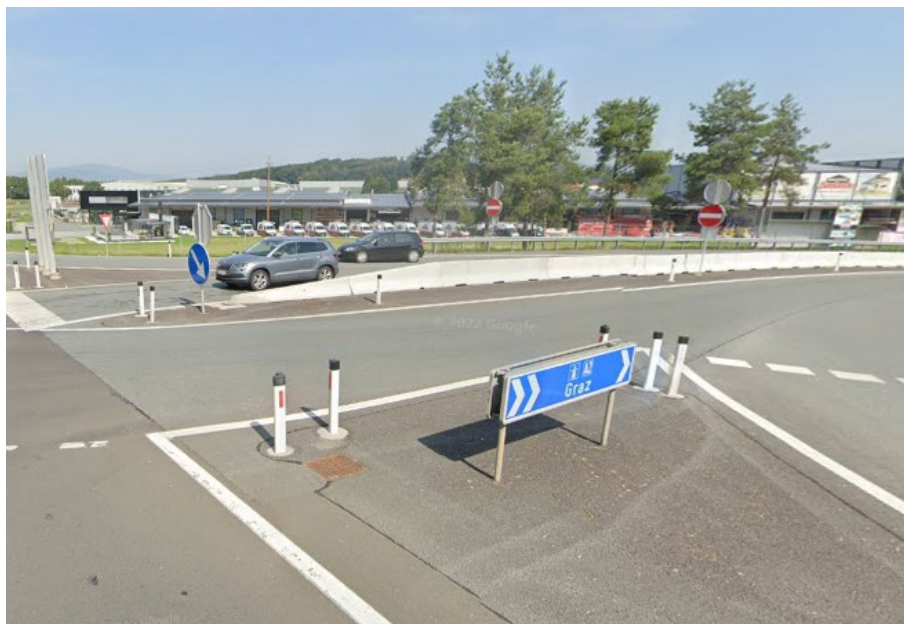
Abbildung 19: Anrampungselemente am Rampenanfang (Quelle: Google Maps)
