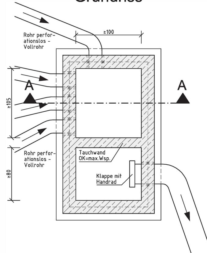
Die Größe des Ablaufdrosselschachtes ist entsprechend des Rohrquerschnittes anzupassen.
